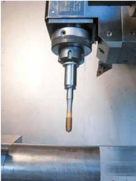
Der neue STA Synchroeinsatz (**Synchro Tapping Adaptor**) wurde speziell für Spannzangenaufnahmen entwickelt und ermöglicht Gewinden und Formen auf Maschinen mit synchronisierter Spindel.
